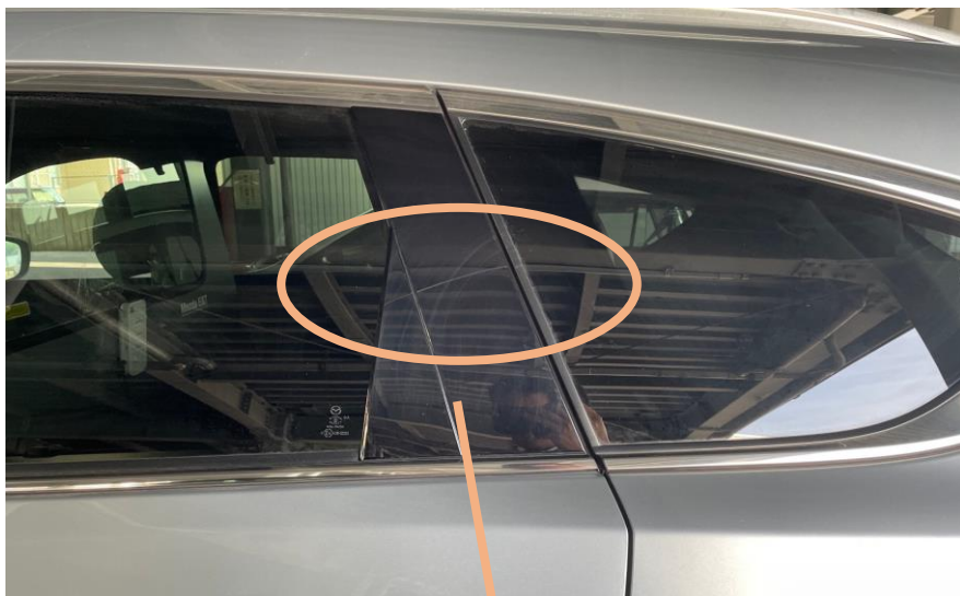
【車両B】①左側後部座席ドア 擦り傷
